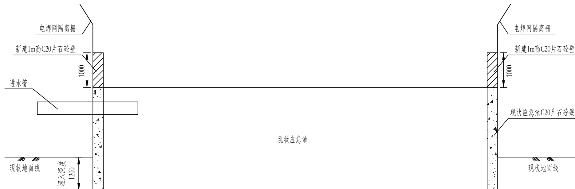
荻芦大桥桥下应急池改造平面图
